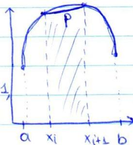
$$Q_{n+1}^T(f) = \frac{h}{2} [f(x_0) + f(x_1)] + \frac{h}{2} [f(x_1) + f(x_2)] + \dots + \frac{h}{2} [f(x_{n-1}) + f(x_n)]$$
