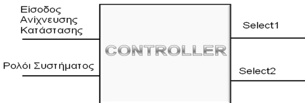
Σχήμα 4.4 Ο Controller Παραγωγής των Σημάτων που Ελέγχουν την Κατάσταση Ύπνου του Κυκλώματος
