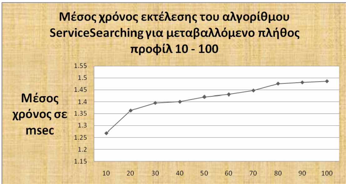
Σχήμα 5.20 Μέσος χρόνος εκτέλεσης του ServiceSearching για μεταβαλλόμενο πλήθος από προφίλ 10 – 100 με δύο δεδομένα εισόδου
