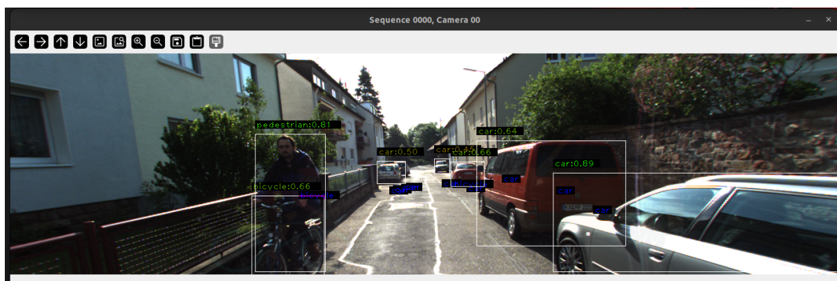
Σχήμα 4.17: Αναγνώριση Διαφορετικών Αντικειμένων Ενδιαφέροντος μέσω Υπολογιστικής Όρασης / Μηχανικής Μάθησης.
