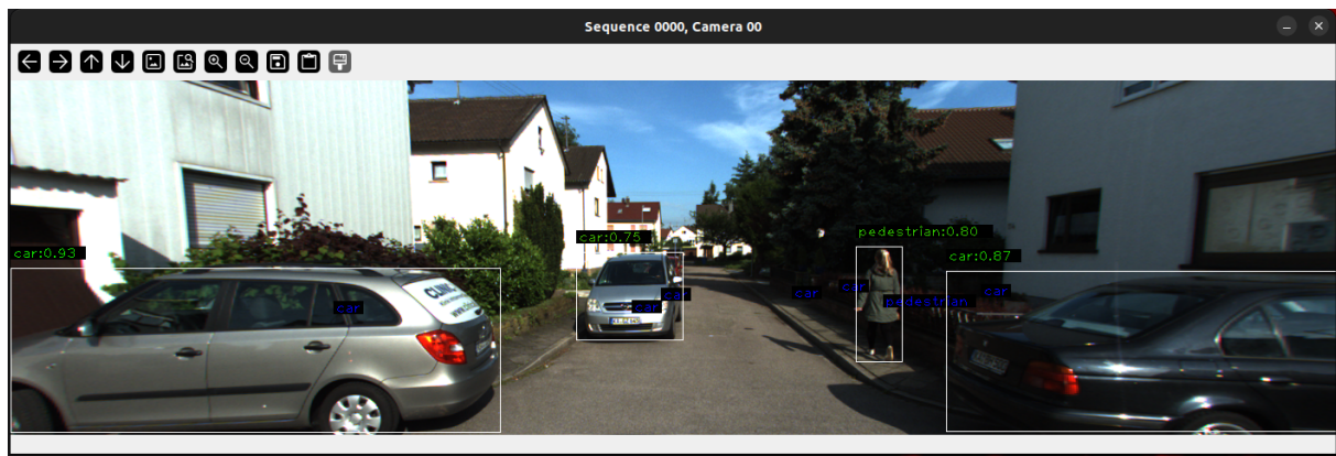
Σχήμα 4.17: Αναγνώριση Διαφορετικών Αντικειμένων Ενδιαφέροντος μέσω Υπολογιστικής Όρασης / Μηχανικής Μάθησης.
