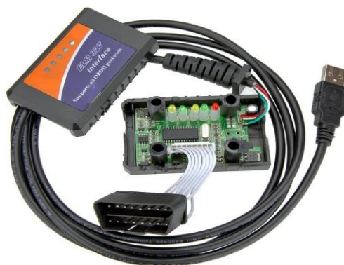
Σχήμα 3.3 Κλώνος του ELM327 Χωρίς Έκδοση του Πρωτοκόλλου
