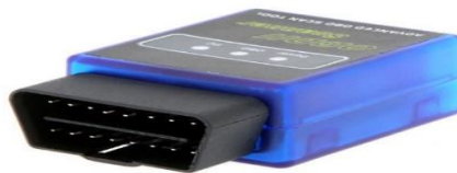
Σχήμα 2.6 Καταγραφέας Δεδομένων Χωρίς Δυνατότητα Αποθήκευσης
