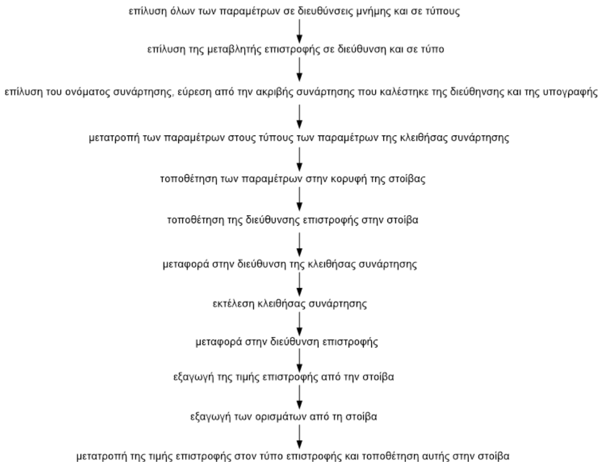
Σχήμα 4.4: Ενέργειες που επιτελούνται στην στοίβα κλήσεων για μία κλήση συνάρτησης.
