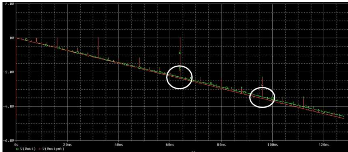
Σχήμα 4.15 Απόκριση του κυκλώματος μετά από τη διόρθωση της αντίστασης R_{26} με καθρεπτισμό (διόρθωση με τη χρήση της πρώτης τεχνικής).
