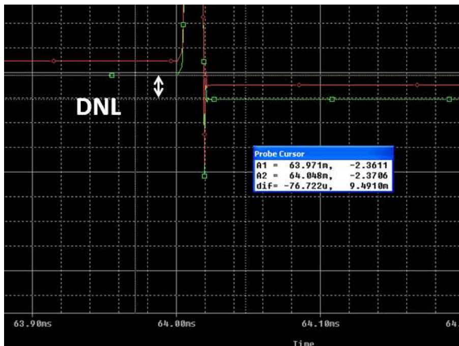
Σχήμα 4.19 Στιγμιότυπο σφάλματος DNL μετά την εφαρμογή της δεύτερης τεχνικής διόρθωσης.
