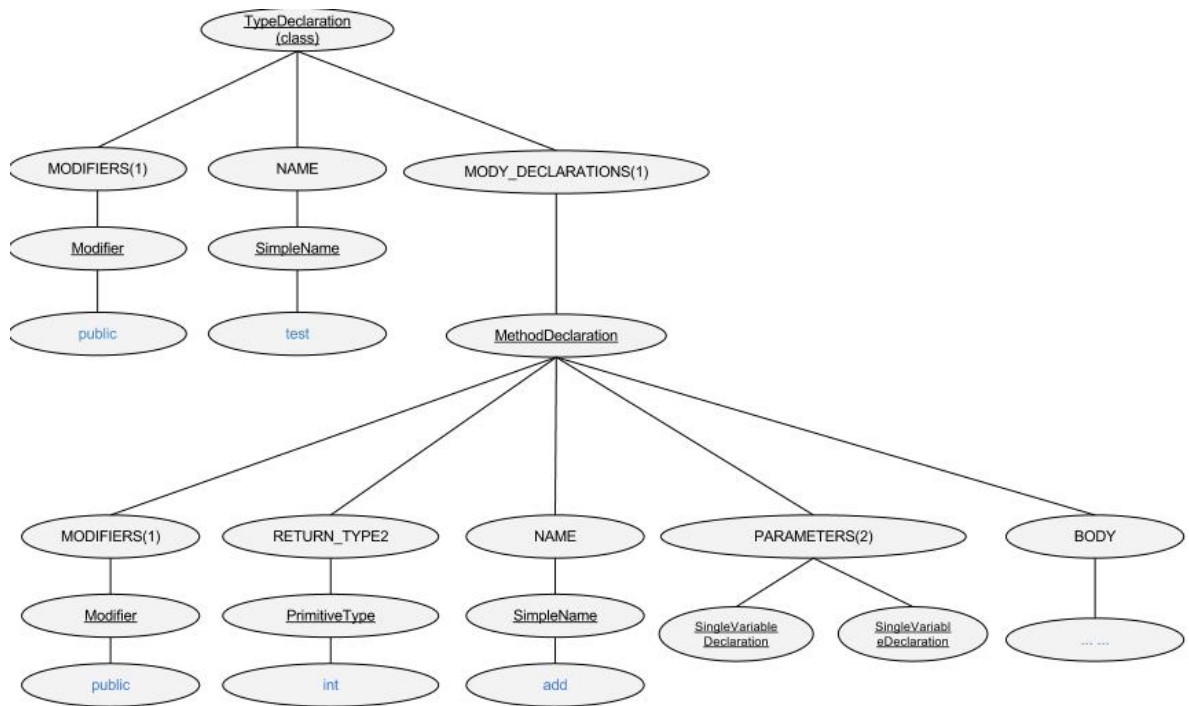
Σχήμα 4.9 Το αφηρημένο συντακτικό δένδρο για την κλάση Test.
